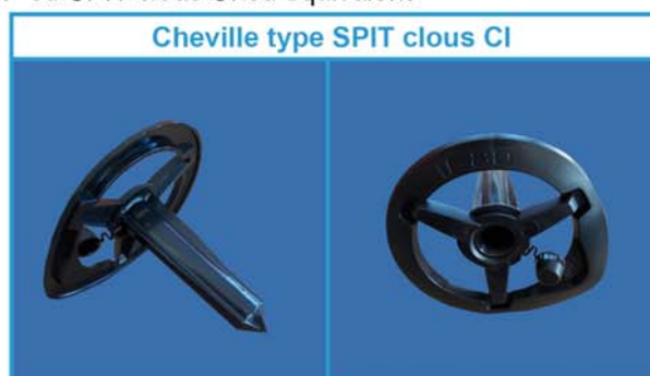
Fixer mécaniquement les panneaux à l'aide de chevilles (au moins deux fixations par panneau, à 15 cm du bord): - Pour les corps creux, utiliser des chevilles de type HILTI clous IDP-L ou équivalent - Pour les corps pleins, utiliser des chevilles de type HILTI clous IDP ou SPIT clous CI ou équivalent
