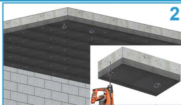
Fixer mécaniquement les panneaux à l'aide de chevilles (au moins deux fixations par panneau, à 15 cm du bord): - Pour les corps creux, utiliser des chevilles de type HILTI clous IDP-L ou équivalent - Pour les corps pleins, utiliser des chevilles de type HILTI clous IDP ou SPIT clous CI ou équivalent
